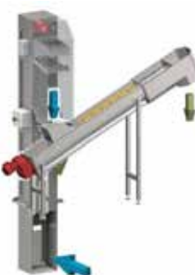
Le dégrilleur actuel Principe de dégrilleur automatique
